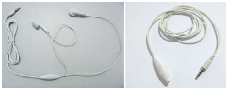
Figura 5.5 - Fones de ouvido da marca Motorola. A esquerda o fone da maneira que é entregue ao consumidor e a direita customizado para servir de microfone de lapela.
